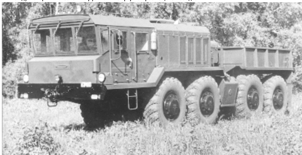
Балластный тягач КЗКТ-74282 первых серий, г. Курган, 1991 г. Передняя панель кабины без подштамповок, переднее буксирное устройство и фара для освещения. Между моторным отсеком и грузовой платформой размещена лебёдка.
