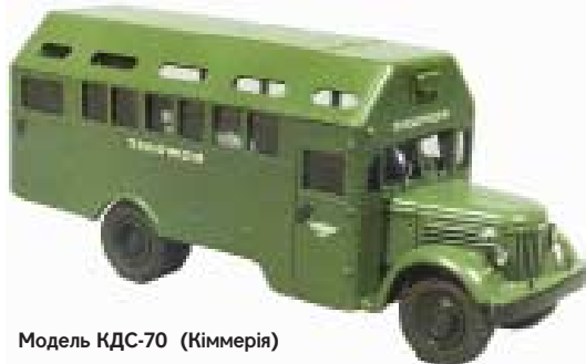
КДС-70. Кислорододобывающая станция на базе шасси МАЗ-200. (Калининградская обл., август 2001 г.)
